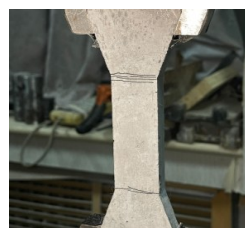
(a) ECC 狗骨形试件拉伸破坏 (b) ECC 立方体抗压破坏
